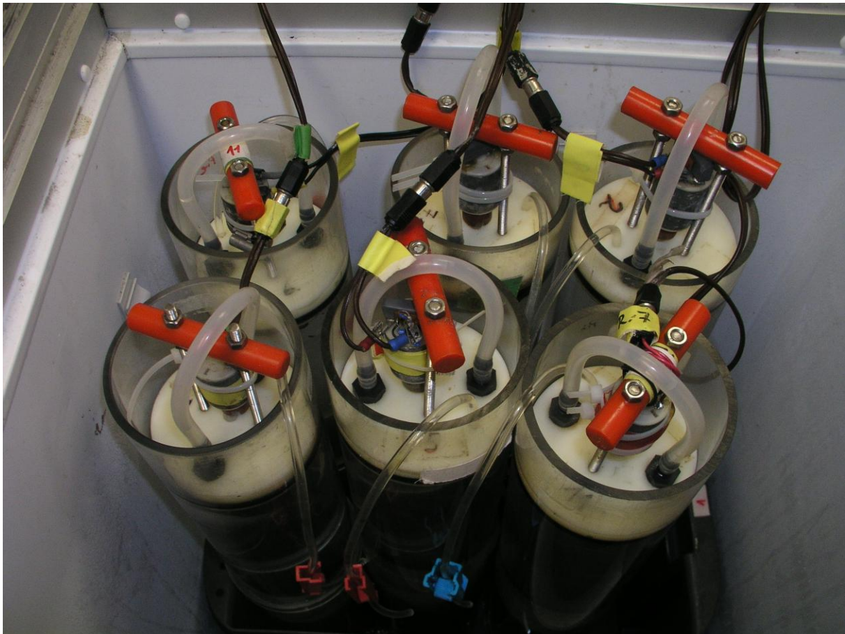
Abb. 10: Inkubationskerne zur Messung von Sauerstoffzehrungsraten im Sediment und in mit Muscheln angereicherten Kernen.
