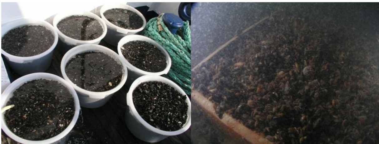
Abb. 9: Vor der Exposition im „Muschelbeet“ (rechts) wurden im Umfeld der Darßer Schwelle ca. 250 kg Miesmuscheln gedreht (links). Die ca. 15 cm hoch aufgeschütteten Miesmuscheln sollten einen Biomasseexport von den Fundamenten simulieren.
