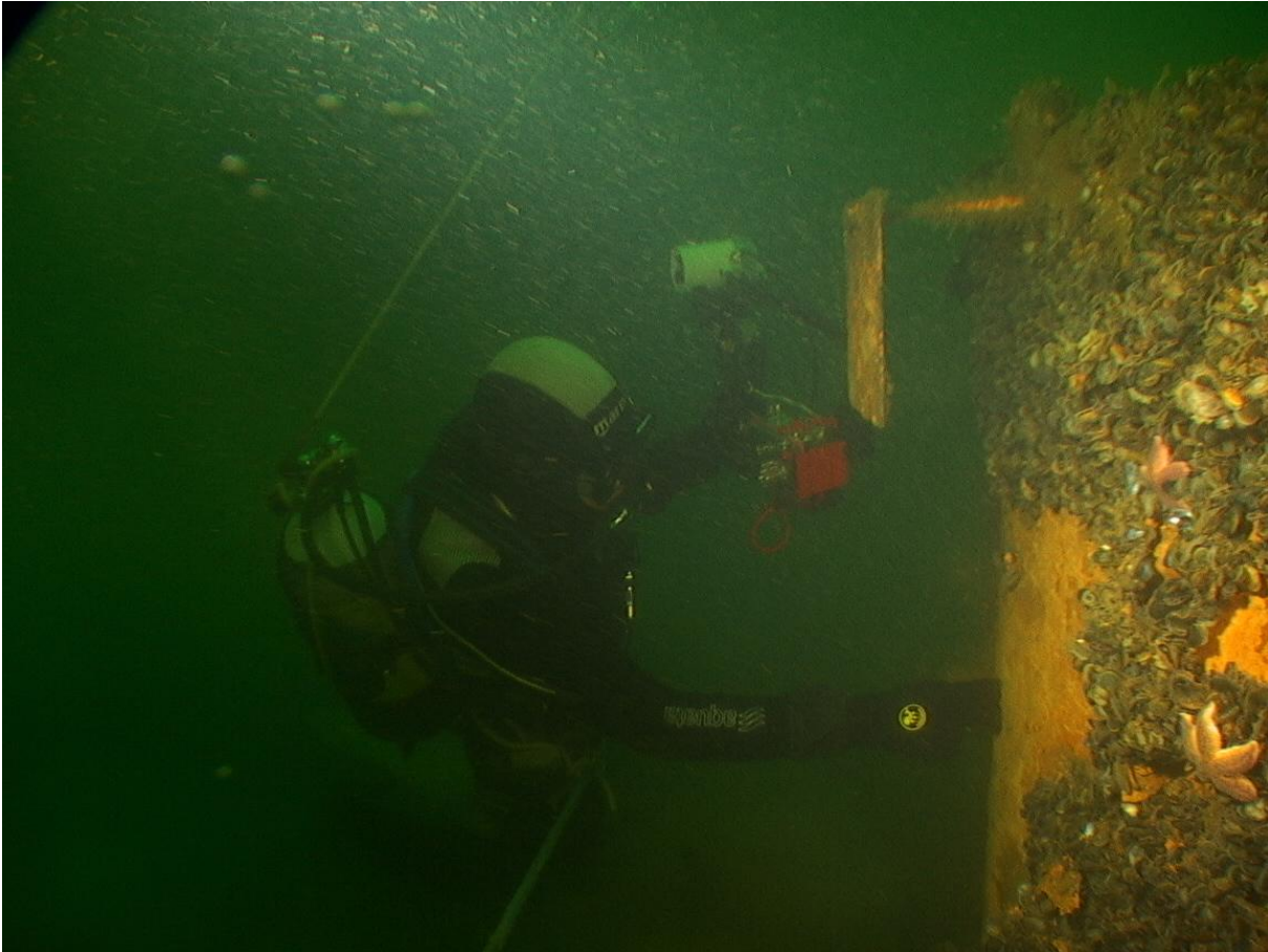
Abb. 6: Taucher führt Untersuchungen am SRZ durch. Deutlich sichtbar sind die Bewuchsplatte am SRZ und die Stelle der Kratzprobe am SRZ zu sehen.
