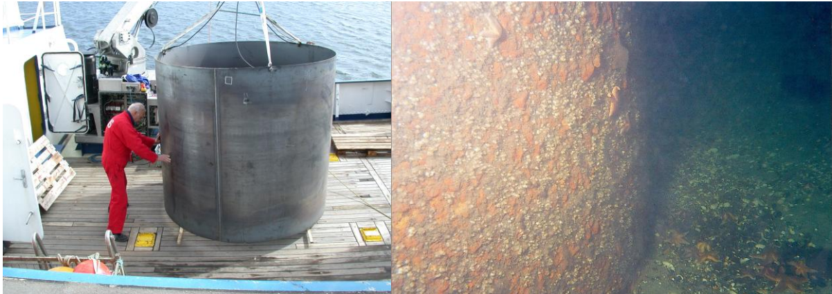
Abb. 2: Stahlrohrzylinder (SRZ), welches in BeoFINO 1 (im April 2003) im Messfeld des IOW an der Darßer Schwelle ausgebracht wurde, um ein Fundament einer WEA zu simulieren. Rechts ist der SRZ nach ca. 2 Jahren Exposition unter Wasser zu sehen.
